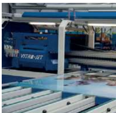
In höchster Qualität können hier Glaselemente bedruckt und so beispielsweise ganze Fassaden verkleidet werden.
