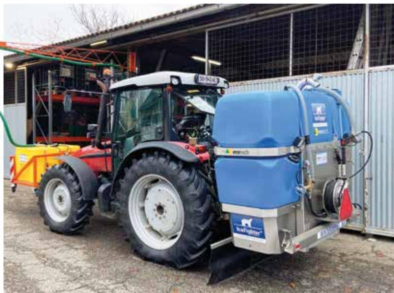
Die Betankung des 450 l Soletanks und des IceFighter® Solesprühers erfolgt über einen Schwenkarm aus dem Solelager, das von den Bauhofmitarbeitern eigenständig geplant und angelegt wurde. Derzeit bevorratet das Lager 7.000 l und wird zukünftig auf 12.000 Liter Sole ausgebaut.
