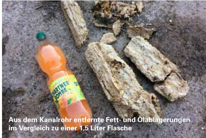
Aus dem Kanalrohr entfernte Fett- und Ölablagerungen im Vergleich zu einer 1,5 Liter Flasche
