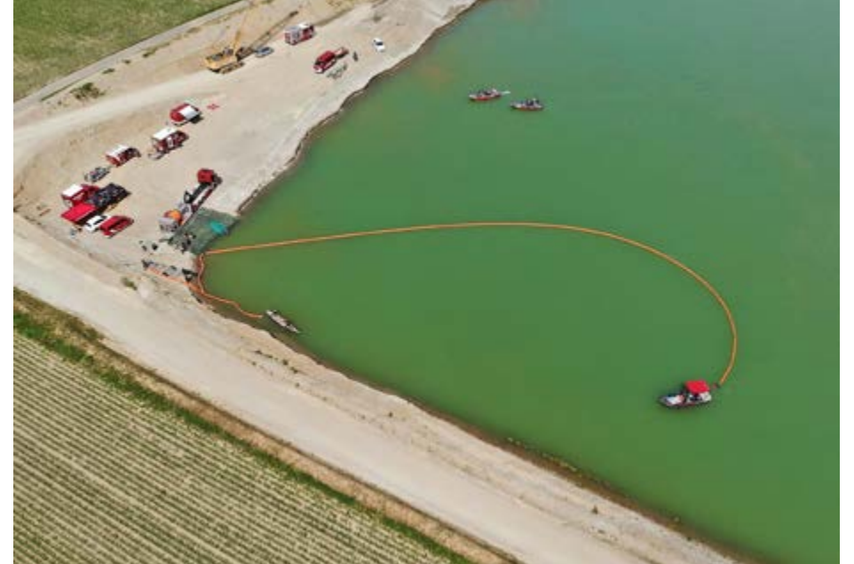
Aufziehen von Ölsperren mit dem Boot. Foto: Drohne BFVRA
