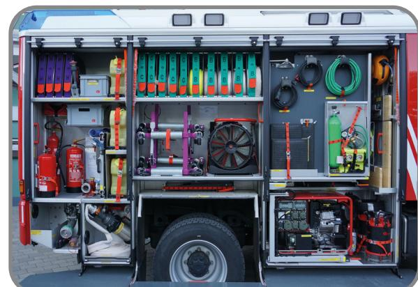
Das Fahrzeug hat ein höchstzulässiges Gesamtgewicht von 16 Tonnen und eine Leistung von 320 PS. Allradantrieb und Differentialsperren sowie ein automatisiertes 12 Ganggetriebe gehören ebenfalls zum Ausstattungsumfang.
