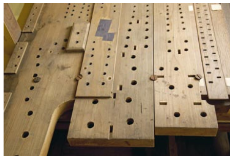
Hier handelt es sich um die „Pfeifenstöcke“. Diese verteilen den Wind, der von der Windlade kommt, auf die Pfeifen; in den Bohrungen stehen die Pfeifen.
