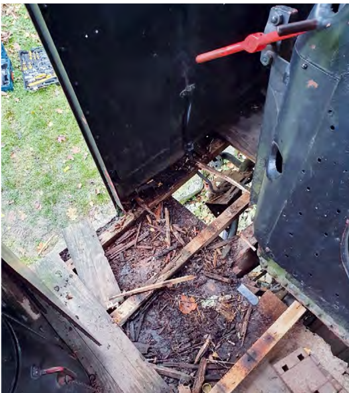
Morscher Untergrund im Führerstand stellte eine Gefahr dar.
