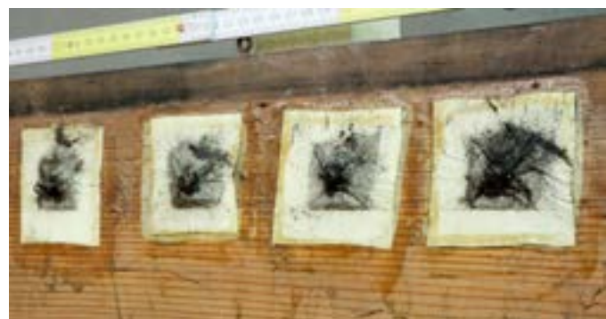
Auch nach erster Reinigung ist noch zu sehen, wie sich Ruß und Staub an Verschlusskanten und porös gewordenen Abzugsdichtungen aus Leder abgesetzt haben.
