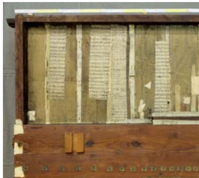
Mit Papier in mehreren Jahrhunderten wiederholt überklebte Risse der Windlade.
