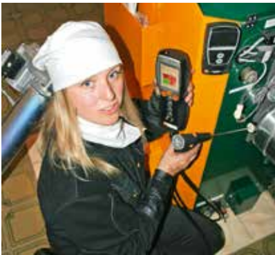
Schadstoffanalyse bei einer Festbrennstoffheizung
