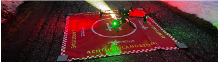
Ausgestattet mit einer Wärmebildkamera, erkennt die Drohne rechtzeitig Glutnester
