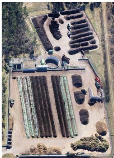
Auf über 90 Meter langen Zeilen wird der Biomüll mit frisch gehäckseltem Grünschnitt vermischt und dann unter freiem Himmel der Arbeit von Mikroorganismen überlassen. Diese „fressen“ Organisches auf, töten mögliche Krankheitserreger ab und erzeugen dabei wertvollen Humus. Die Zeilen werden jede Woche bewässert
