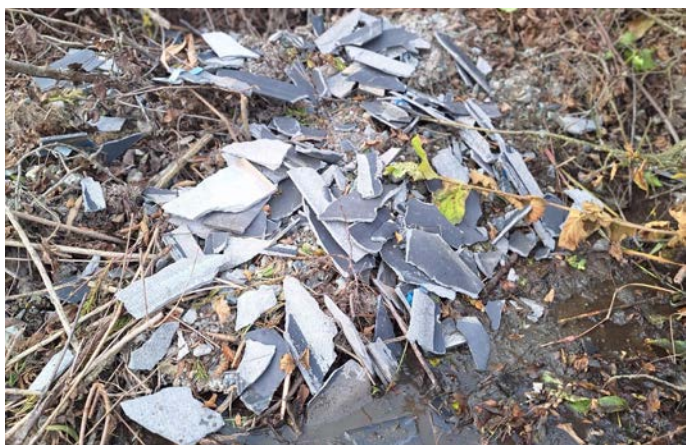
... ebenso wenig Eternit-Platten!
