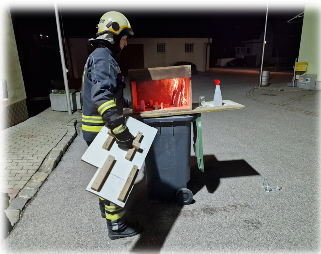
Simulation ventilationsgesteuerte Brände
