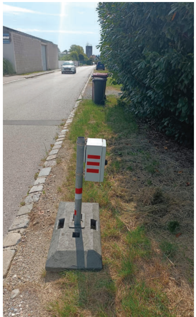
Das Verkehrszählgerät wurde an mehreren Standorten in Steinbrunn aufgestellt, um die Anzahl der Fahrzeuge und deren Geschwindigkeit zu erfassen.
