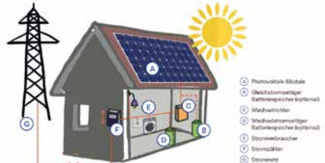
Abbildung 3: typische Bestandteile einer PV-Anlage (Quelle: www.pv-voelk.at)
