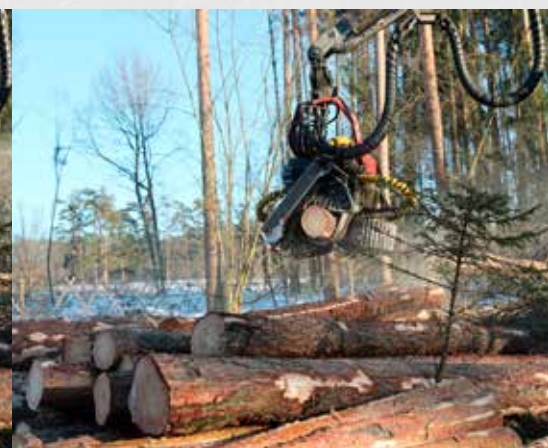
Harvester-Arbeit im Gemeindewald: Es dauert keine fünf Minuten, bis ein Baum gefällt, entastet und der Stamm in transportfähige Bloche geschnitten ist. Gleichzeitig werden letztere so gestapelt, dass sie problemlos abtransportiert werden können.
