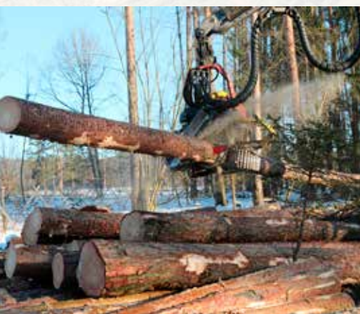
Harvester-Arbeit im Gemeindewald: Es dauert keine fünf Minuten, bis ein Baum gefällt, entastet und der Stamm in transportfähige Bloche geschnitten ist. Gleichzeitig werden letztere so gestapelt, dass sie problemlos abtransportiert werden können.
