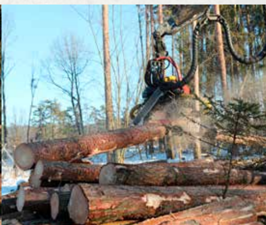
Harvester-Arbeit im Gemeindewald: Es dauert keine fünf Minuten, bis ein Baum gefällt, entastet und der Stamm in transportfähige Bloche geschnitten ist. Gleichzeitig werden letztere so gestapelt, dass sie problemlos abtransportiert werden können.
