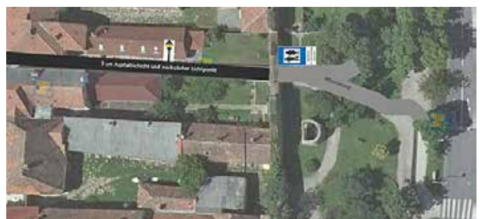
Im „Listgasserl“ wird eine 3cm dicke Asphaltschicht aufgetragen und ein Gefälle hergestellt damit das Wasser von den angrenzenden Mauern und Gebäuden ablaufen kann. Ein zusätzlicher Lichtpunkt in der Mitte ist für eine ausreichende Beleuchtung notwendig. Mittels Erklärung zur Fußgängerzone kann das Radfahren (im Schritttempo) gestattet werden.
