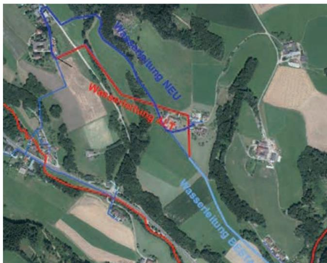
Die neue Trasse der Wasserleitung wird nun entlang des Güterwegs verlegt.
