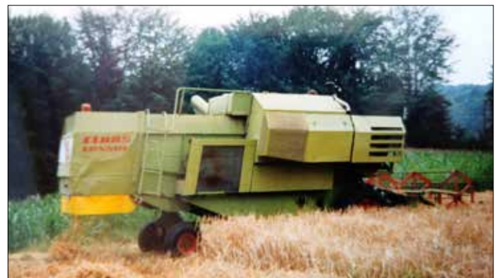
Mährescher Claas Consul: Baujahr 1968 mit 2,60 Meter Schnittbreite, 68 PS und Vierzylinder Perkins Motor Foto: Erster Mährescher von Georg Roth
