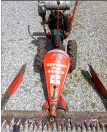
Motormäher Reform 158 Super mit einer Schnittbreite 1,33 Metern (Baujahr 1973) Foto: Georg Roth
