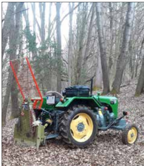
Der „15er Steyr“ Traktor (Baujahr 1955) erleichtert mit der Seilwinde die harte Arbeit (c) Georg Roth
