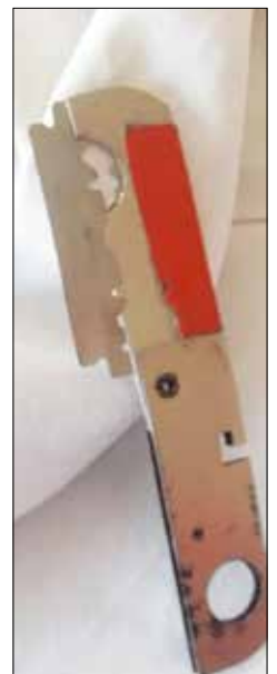
Klinge zum Auftrennen von Kleidung
