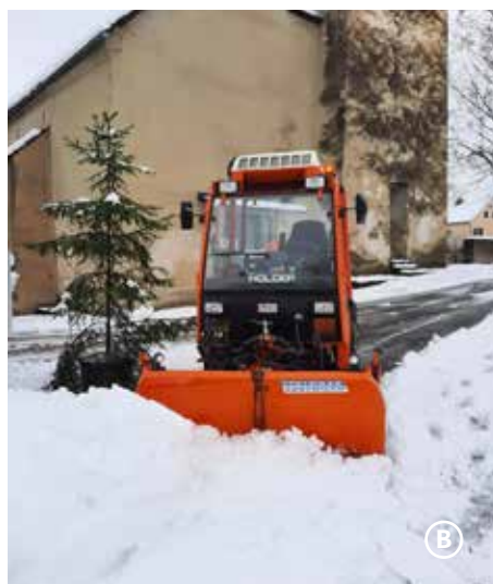
Heuer war bereits Ende November eine Schneerräumung erforderlich. In die Fahrbahn ragende Äste erschweren die Arbeit. (A). Bei Gehsteigen bzw. Plätzen leistet unser Holder wertvolle Dienste (B). Die Salz- und Streusplittstreuung wird mit unserem gemeindeeigenen Traktor durchgeführt (C).
