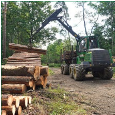
Der mit dem Harvester digital verbundene Forwarder transportiert das Holz von der Waldfläche bis hin zur Forststraße.
