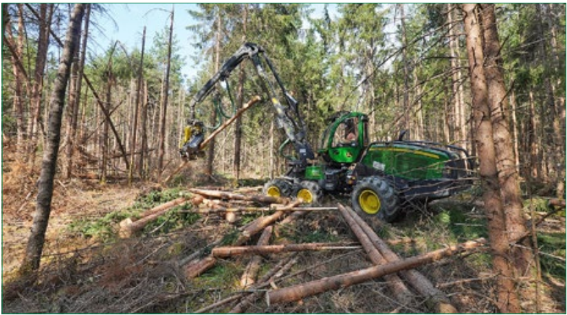
In Fürstenfelds Beständen kommt bei der Holzernte auf sogenannten „Rückegassen“ mo- dernste Harvester-Technologie von qualifizierten regionalen Dienstleistern zum Einsatz.
